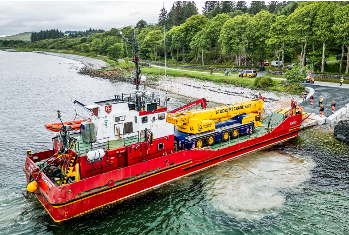
Mission accomplished Der LTM 1230-5.1 tritt seine Rückreise zum schottischen Festland an. Die provisorische Anlegestelle wurde eigens für das Transportschiff gebaut.
